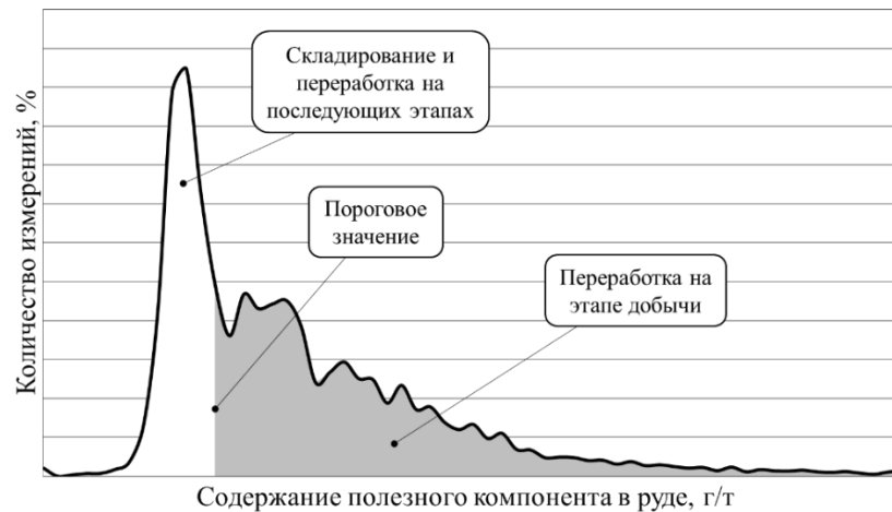
Рисунок 2.15 – График статистики распределения содержания полезного компонента в руде с разделением на этапы переработки по пороговому значению
