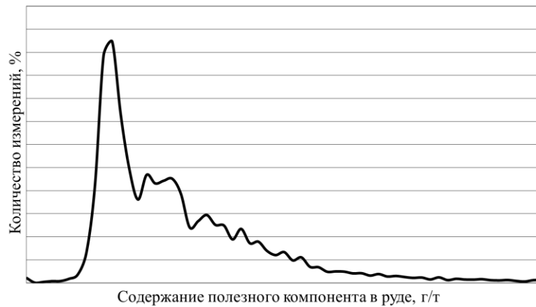
Рисунок 2.13 – График распределения содержания полезного компонента в руде
