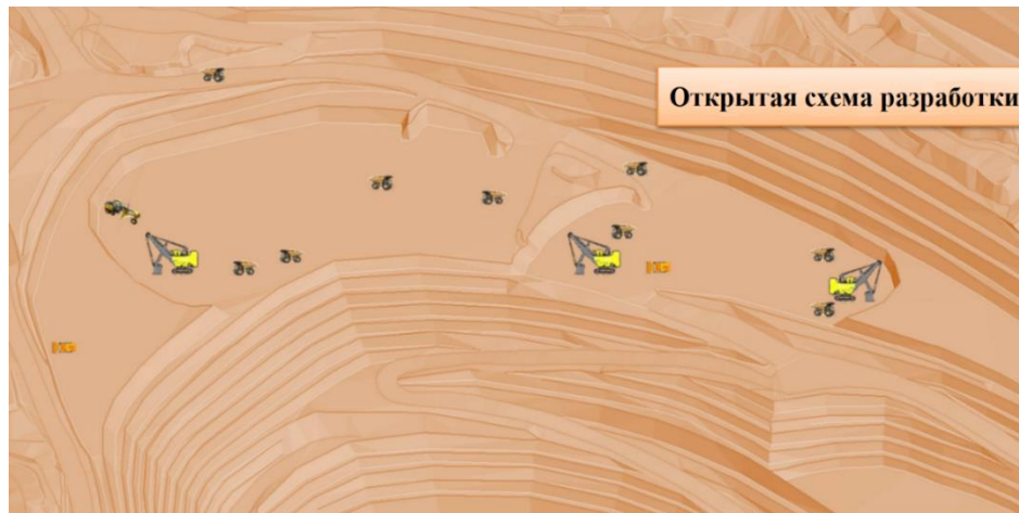
Рисунок 2.5 – План карьера с применением трех экскаваторов
